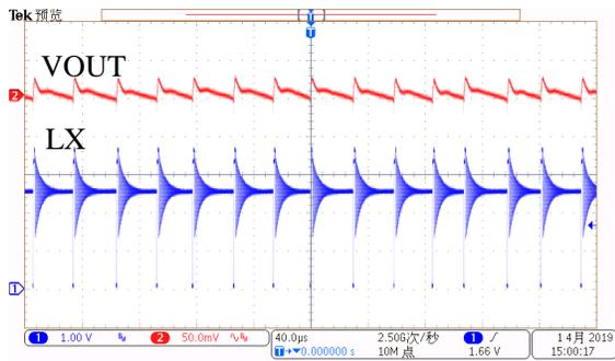
9、PWM 工作波形  $V_{IN}=2.5V$ ,  $V_{OUT}=3.3V$ ,  $I_{LOAD}=500mA$
