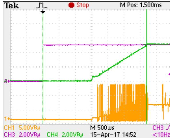
CH1= $V_{sw}$ , CH3= $V_{EN}$ , CH4= $V_{OUT}$
