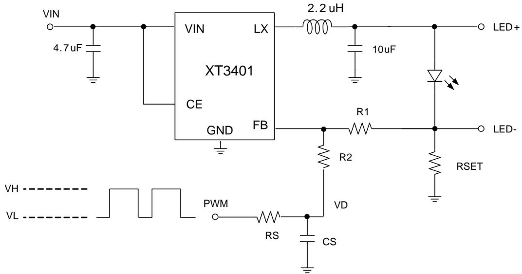
RS 和 CS 的值取决于 PWM 调光的频率，频率越低则 RS 和 CS 的值要选择越大。
