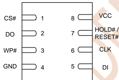
Figure 3.2 DFN8 (5\*6 mm)
